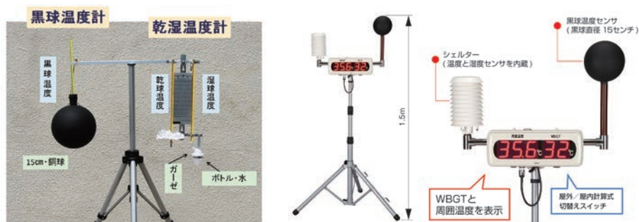
図1-19 暑さ指数(WBGT)測定装置 (左) 基本型 (右) 電子式
